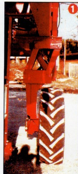
1 Carreggiata stretta in fase di trasferimento su strada (m. 2,10) Road transport wheel tread (m. 2,10)
