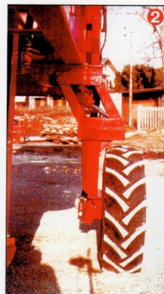
2 Carreggiata larga in fase di lavoro (m. 3,44) Working wheel tread (m. 3,44)
